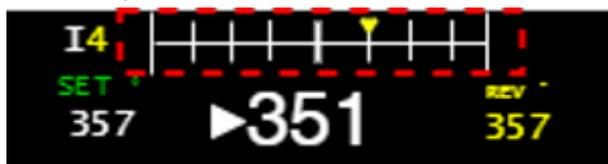
Se la differenza tra la rotta corrente e l'angolo di setpoint è superiore a  $\pm 20^\circ$ , la freccia viene saturata all'estremità sinistra / destra della scala graduata.
