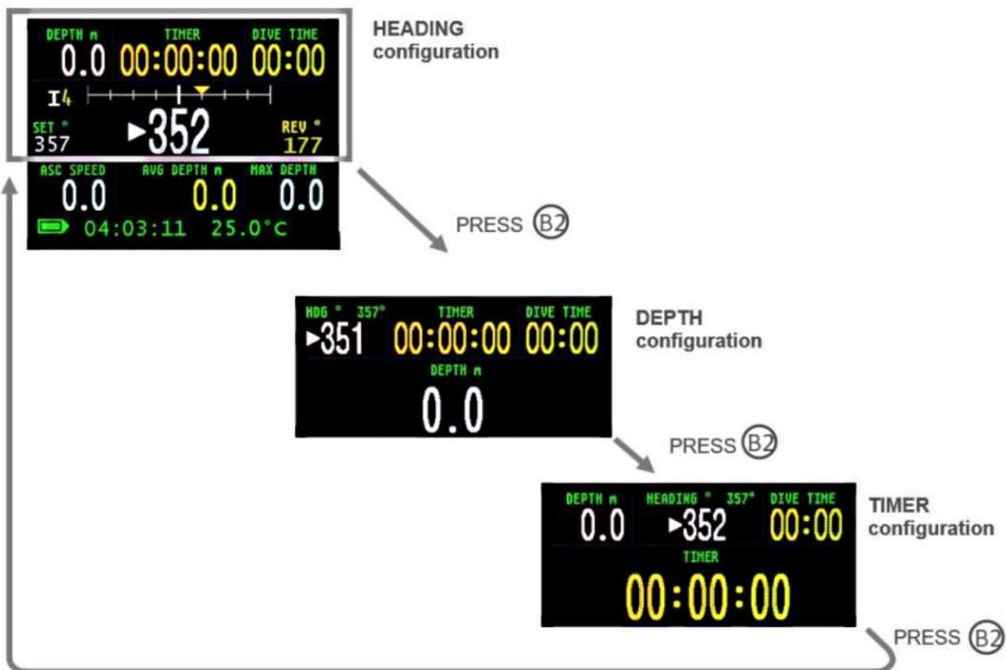
Fig 143 - Configurazioni delle righe superiori e centrali
