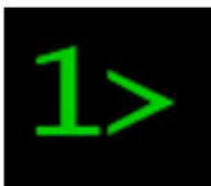
Quando il computer riceve i dati dallo Scooter SUEX sul bordo destro, viene visualizzato l'indirizzo dello Scooter (1) e il simbolo (>) in colore verde. Se il messaggio ricevuto è sbagliato viene visualizzato il simbolo (>) di colore rosso.
