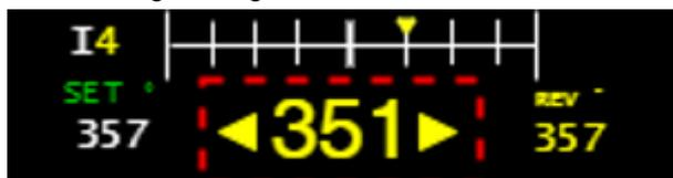
Se non è impostato alcun punto di rotta, viene visualizzata solo la bussola e non viene visualizzata alcuna freccia.
