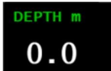
**Fig 130 - Metric: in metri (display con 1 decimale fino a 999,9 m)**
