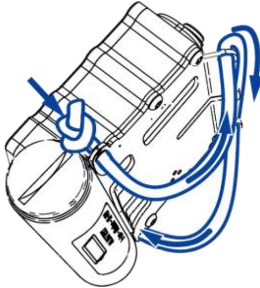
Fig 2 - Installazione del cavo da polso
